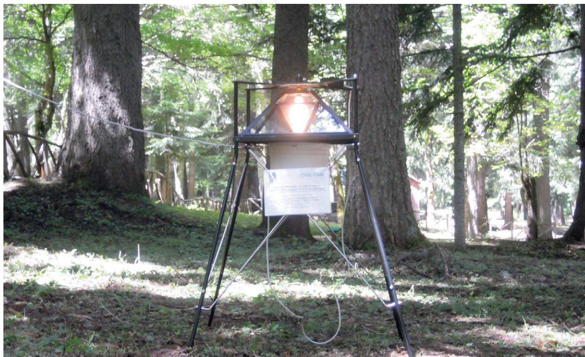
Fig. 2. La trappola Rothamsted utilizzata per i campionamenti installata e attivata nell'Arboreto Sbanditi.
