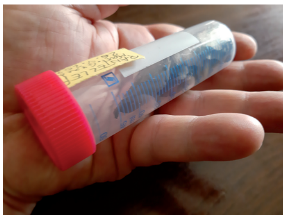
Fig. 13. Provettone (con tappo dotato di piccoli fori) per il trasporto degli esemplari vivi dal campo al laboratorio. Pantelleria, aprile 2021. Foto Paolo Fontana.
